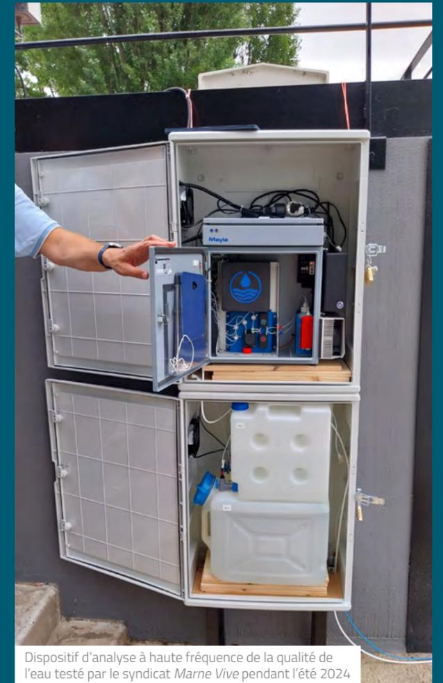
Dispositif d'analyse à haute fréquence de la qualité de l'eau testé par le syndicat Marne Vive pendant l'été 2024
